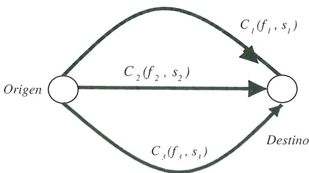
Fig. 2 Un par O/D con tres vías que las conectan y sus tiempos generalizados de viaje.
