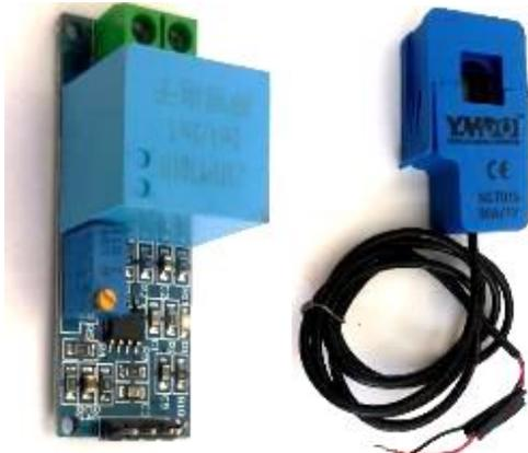
Fig. 2. Módulo ZMPT101B (izquierda) y Módulo SCT013 (derecha)
