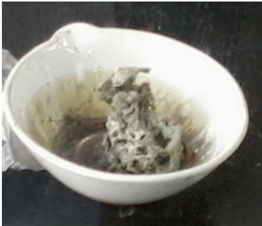
**Figura 1:** Muestra de  $\text{YCrO}_3$  obtenida luego de la combustión.
