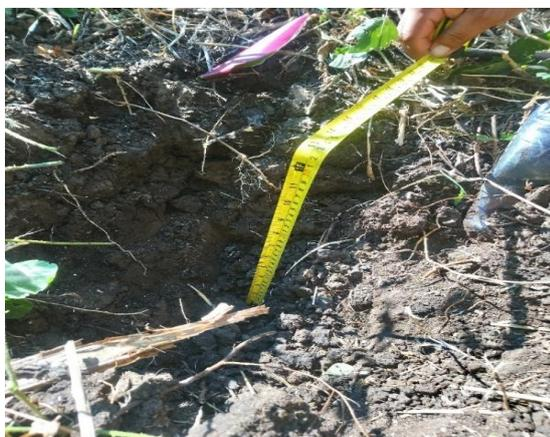
Fig. 2. Calicata de 30cm de profundidad para la extracción de muestras
